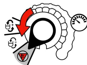
8. Pulire eventuale materiale residuo dai serbatoi di alimentazione. Riempire ogni serbatoio di alimentazione con 3,8-7,6 l (1-2 gall.) di solvente consigliato dal produttore del materiale.
