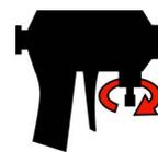
**NOTA:** Nelle pistole a urto, non aprire mai le valvole del collettore del fluido né premere il grilletto della pistola se le pressioni non sono bilanciate.
